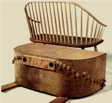
图 7、温莎椅热弯模具
